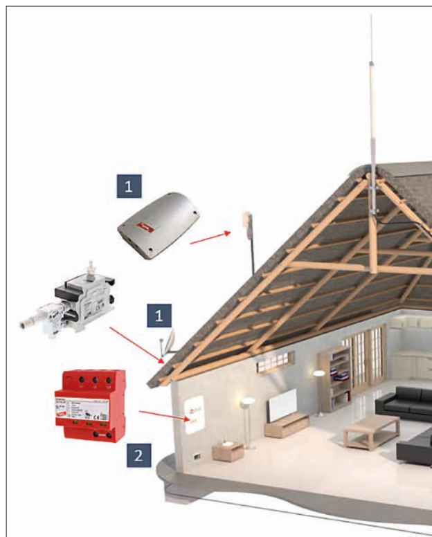
Obr. 10. Vnitřní ochrana proti přepětí
