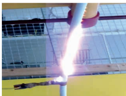
Obr. 6 Simulace zkoušky vysokým napětím vlnou 1,2/50 \mu s vysokonapěťového vodiče ve vysokonapěťové laboratoři na univerzitě v Białystoku
