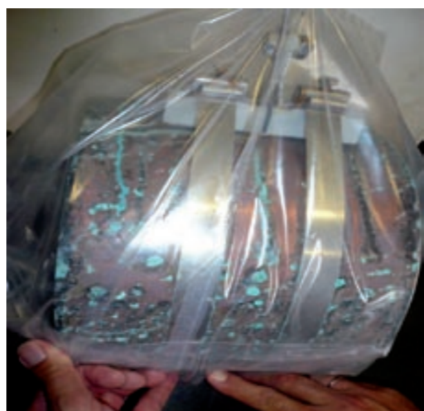
obr. 2 Zkušební vzorek po umělém zestárnutí podle DIN EN 50164-1 (ČSN EN 50164-1)
