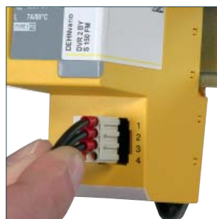
Jednoduché vyjmutí jednotky svorek při výměně svodiče.
