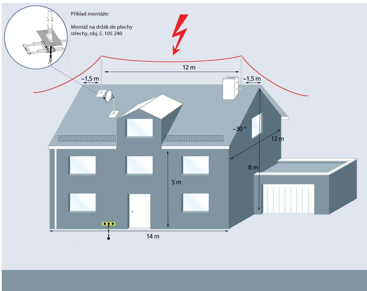
Nezapomenout na vyrovnání potenciálu bleskového proudu! Při zřizování vnější ochrany před bleskem musí ekvipotenciální svorkovnice (např. obj. č. 563 200) odpovídat ČSN EN 50 164-1 pro bleskový proud (10/350 µs).
