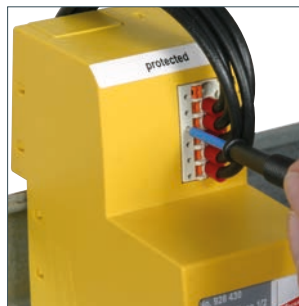
Integrované měřicí otvory pro testování signálových obvodů měřicím hrotem.
