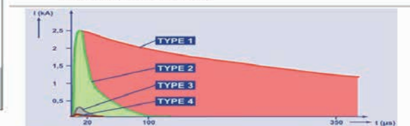
Obr. 7.4i Třídy svodičů - srovnání tvarů vlny (8/20 μs) a (10/350 μs) impulzních proudů
