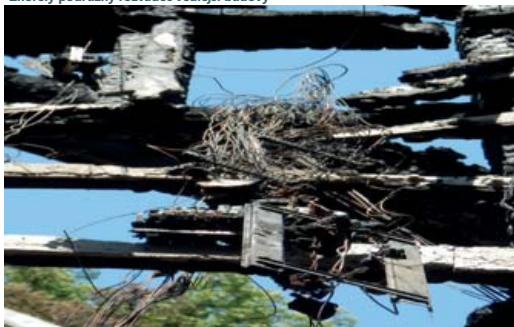
Zhořelý podružný rozváděč vedlejší budovy
