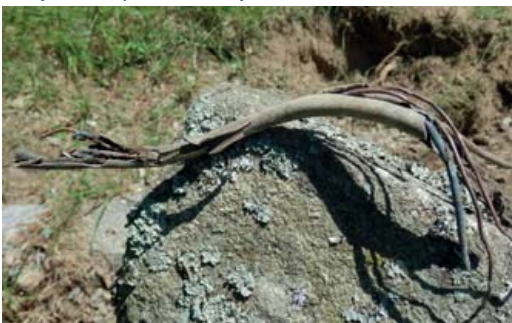
Účinky bleskového proudu na elektrický kabel ohradníku a osvětlení
