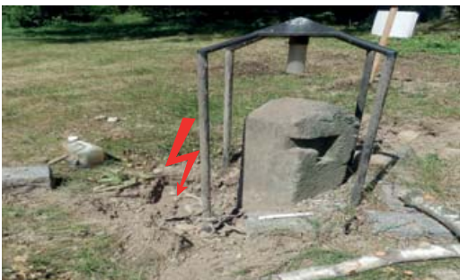
Účinky bleskového proudu na elektrický kabel ohradníku a osvětlení
