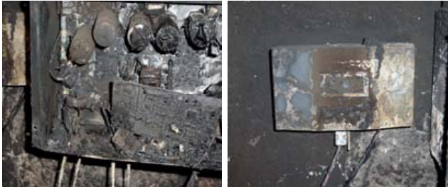
Škody na fotovoltaických panelech vyvolané přímým úderem blesku
