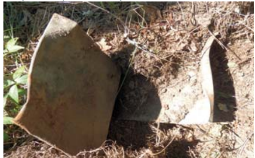
Účinky bleskového proudu na elektrický kabel ohradníku a osvětlení
