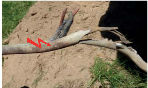
Účinky bleskového proudu na elektrický kabel ohradníku a osvětlení
