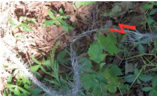
Účinky bleskového proudu na elektrický kabel ohradníku a osvětlení
